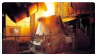
光製鋼工場：AOD炉
