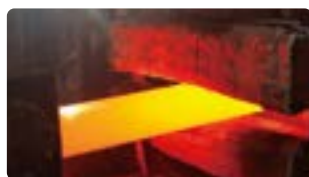
薄板工場：No2焼鈍酸洗ライン
